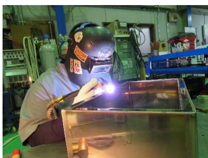
薬品タンクの溶接
